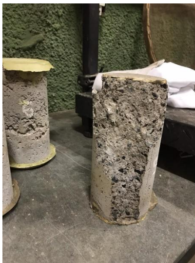
Figura 12 – Corpo de prova do CR após rompimento
